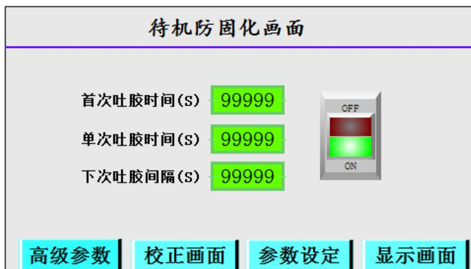
本设备提供混胶管待机防固化出胶功能。
